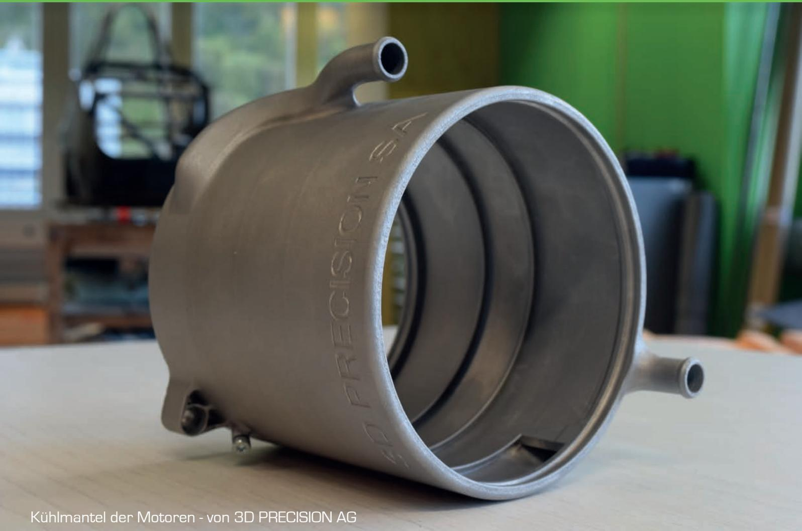
Kühlmantel der Motoren - von 3D PRECISION AG
