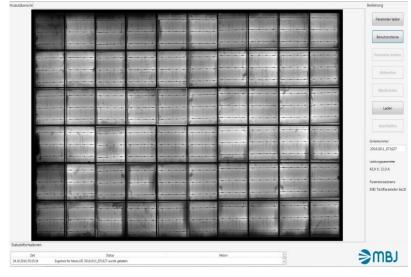
Elektrolumineszenz-Messung eines Solarmoduls zur Ermittlung von Schäden an den Siliziumzellen.
