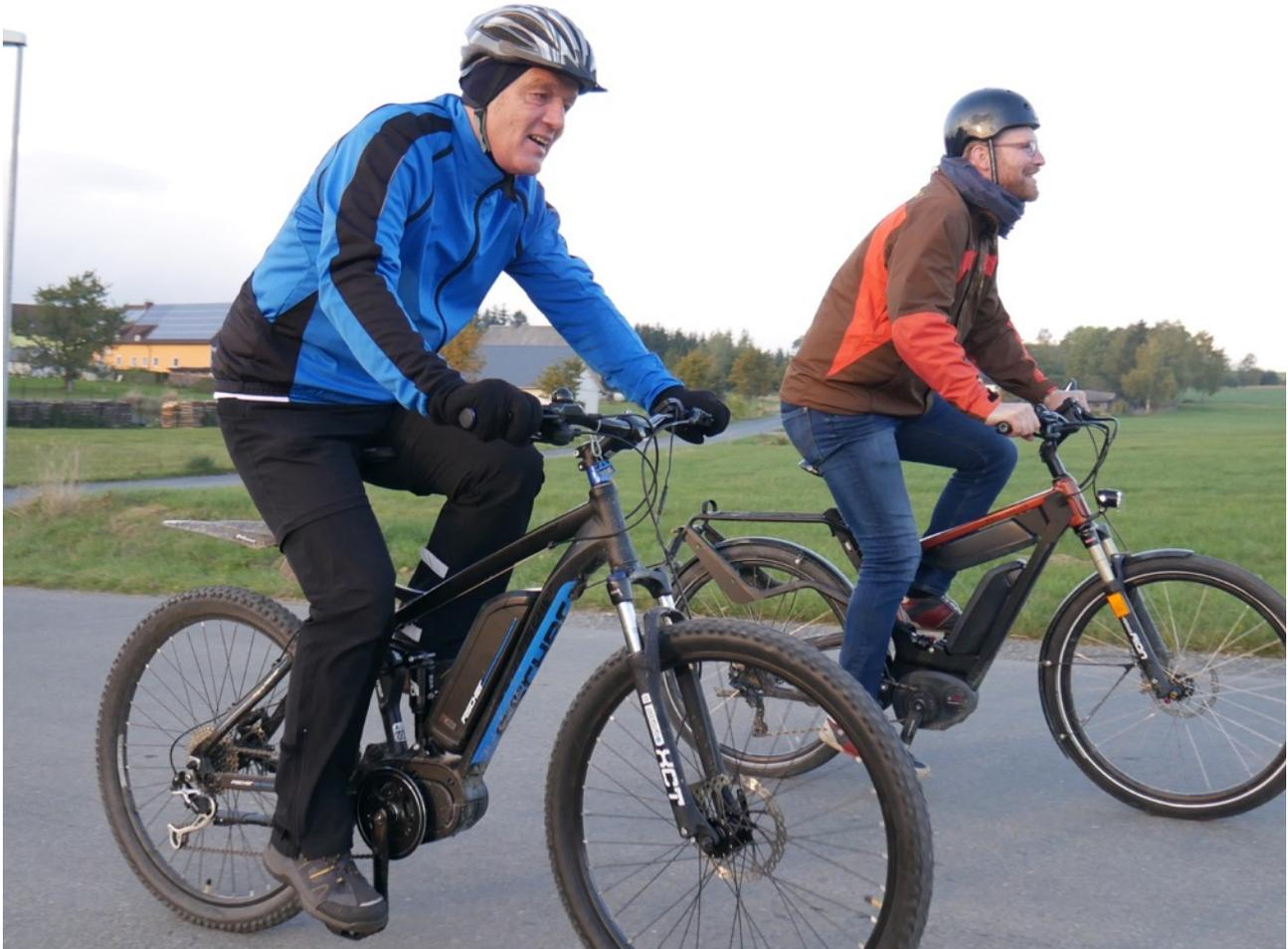
Die Fahrtests werden im thüringischen Tanna und der näheren Umgebung mit bisher einzigartiger und speziell angefertigter Messtechnik gefahren. Die Kennwerte Reichweite, Unterstützung, Effizienz des Antriebs, Durchschnittsgeschwindigkeit u.v.m. werden dabei für Tour-, Berg- und Stadtstrecke ermittelt.
