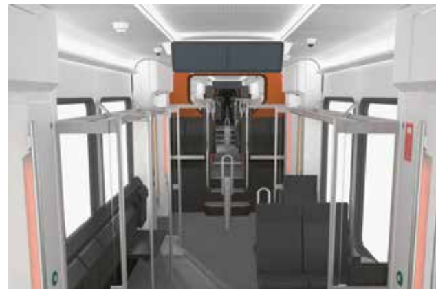
Die erhöhten Viererabteile an den Wagenübergängen eignen sich auch für längere Reisen.
