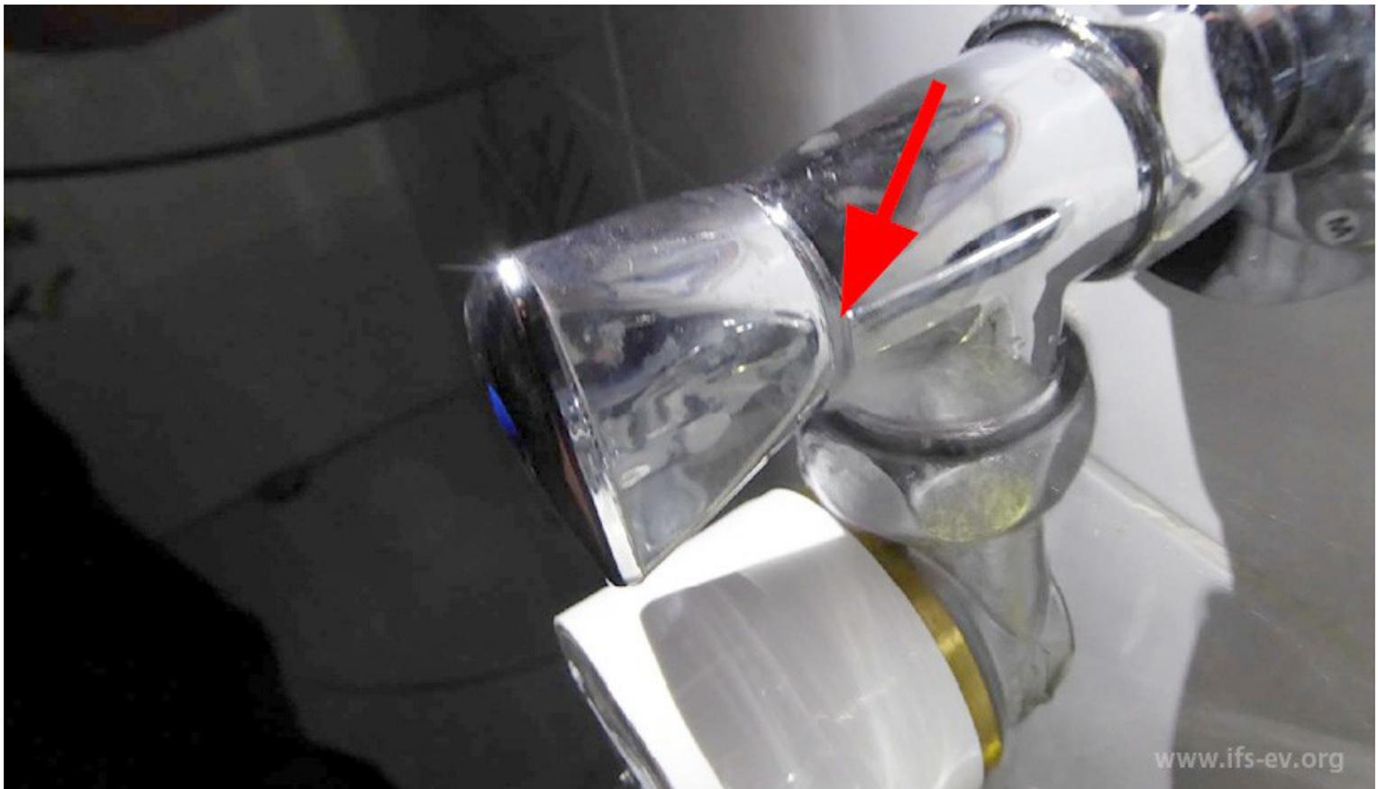
Im Einbauzustand trat das Wasser zwischen Ventilkopf und Gehäuse aus (Pfeil). Foto: [www.ifs-ev.org](http://www.ifs-ev.org).
