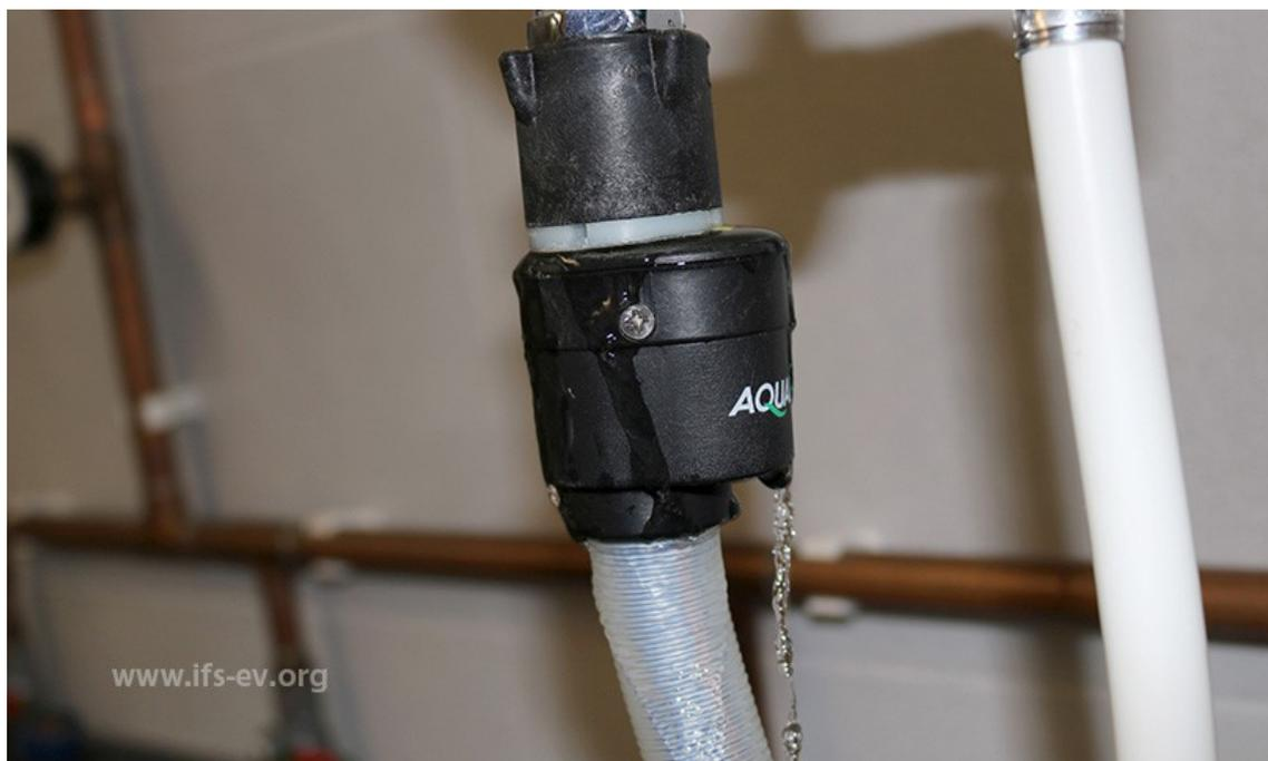
Der Geschirrspüleranschluss bei der Dichtigkeitsprüfung im IFS. Foto: [www.ifs-ev.org](http://www.ifs-ev.org).
