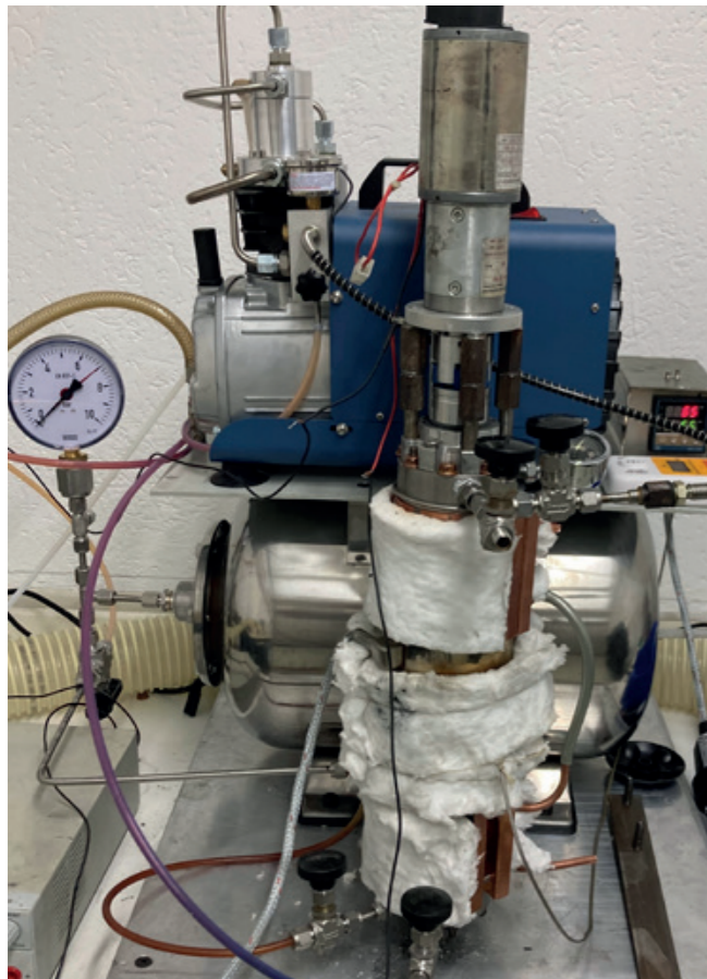
Abbildung 1: Precursorsynthese mittels Autoklaventechnik
