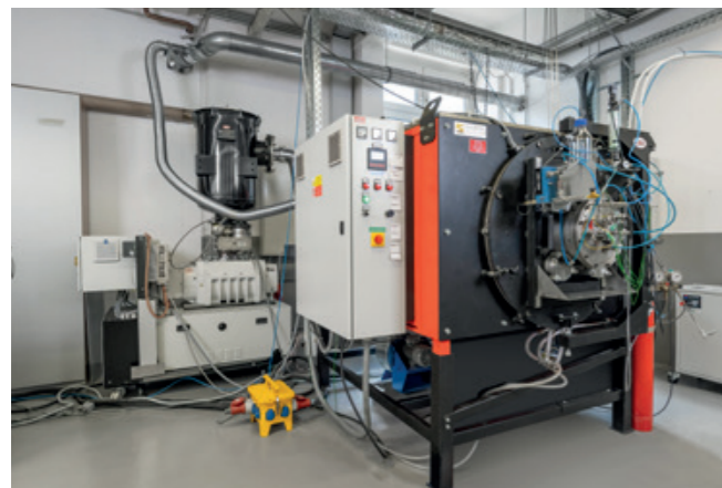
Abbildung 2: Reaktor der CVD 3 mit angeschlossenen Pumpenstand
