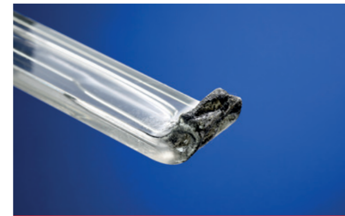
Abbildung 1: Dieseeffekt durch unzureichende Werkzeugentlüftung
