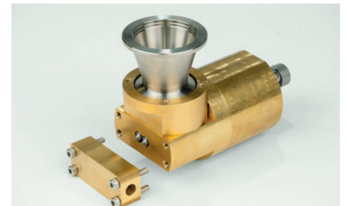
Abbildung 1: Doppelschneckenextruder für pulverförmige Precursoren
