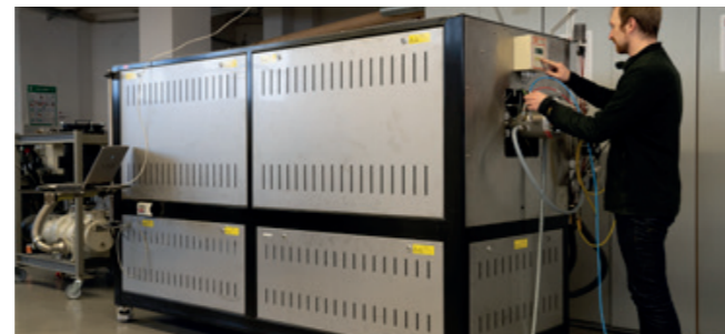
Abbildung 3: CVD 4 mit installierter Mikrowellen-Plasmaquelle
